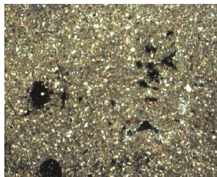
f. torchis limoneux avec débris de végétaux. Log 29b (S3), XPL, l. i. 4 mm.
