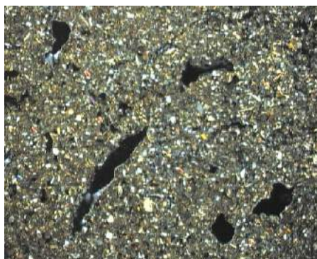
e. torchis limoneux, préparation plus élaborée. S4, PPL, l. i. 4 mm.
